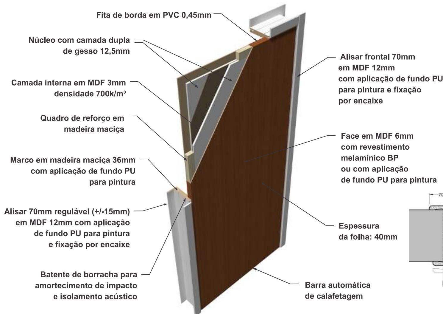
A porta acústica Classic possui folha de núcleo em MDF com camada dupla de gesso, acabamento em MDF melamínico BP ou com aplicação de fundo PU para posterior pintura\*, marco composto com núcleo em madeira maciça com aplicação de fundo PU para posterior pintura\* e guarnição (alizar) em MDF 12mm com aplicação de fundo PU para posterior pintura\*.
